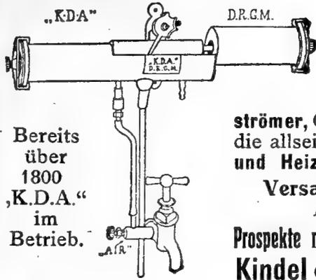
„K.D.A.“ (Kindelscher Durchlüftungs-Apparat), Lufthahn „Air“, unsere Buxbaum-Auströmer, Gasblaubrenner „Perfect“ ergeb. die allseitig anerk. besten Durchlüftungs- und Heizungs-Anlagen der Gegenwart.
